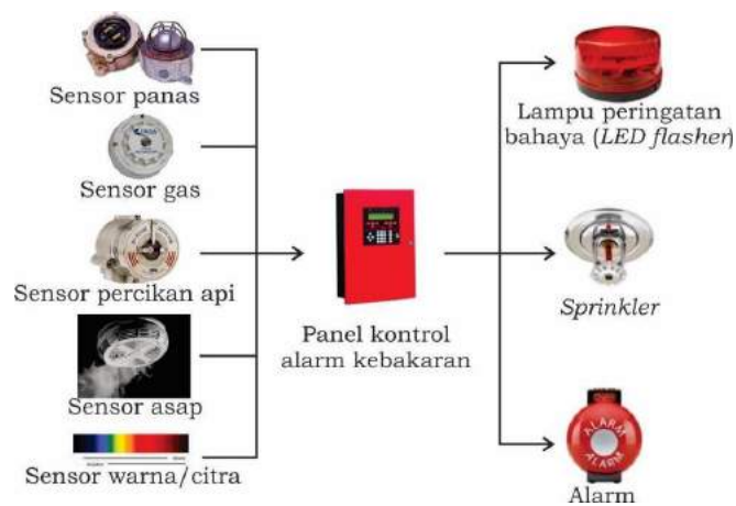
Gambar II.174. Sistem peringatan kebakaran
