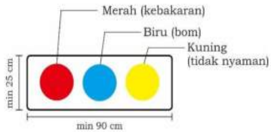
Gambar II.248. Alarm lampu darurat untuk penandang disabilitas rungu
